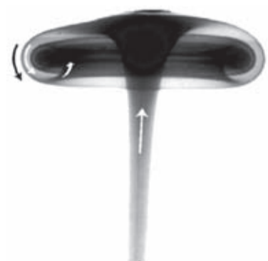
Структура плюма «голова-хвост» в эксперименте Росса Гриффитса и Яна Кэмпбелла [2] (в оригинальной статье низкое качество печати, поэтому рисунок воспроизведен по статье [8]).
